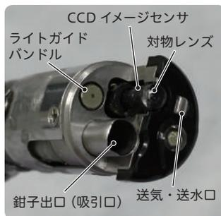
図16 先端部が深の構造
