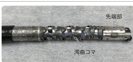
図 3 湾曲ゴムを剥がした湾曲部内部の構造
