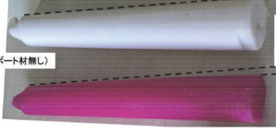
図 1 造形時に自重により変形した例
